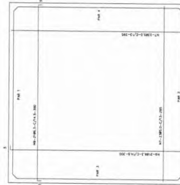
CX D'ÁGUA - ARMADURA - DO FUNDO ESCALA 1/50
